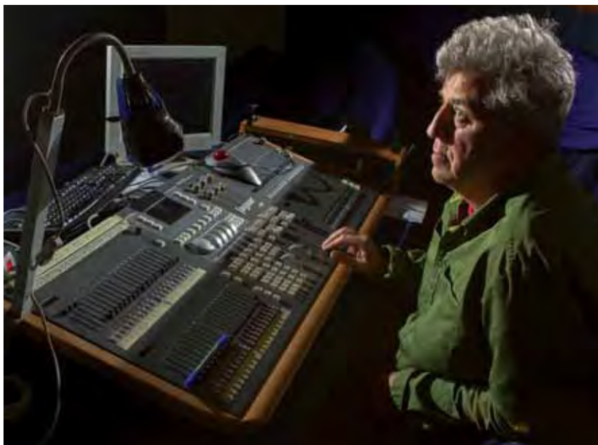
A nagyszínpad világítás-szabályzó pultja. Valójában egy nagyteljesítményű számítógép, amelyen jelenetről-jelenetre megtervezhetők az előadások fényváltásai és „memorizálható” a végleges világítási terv
